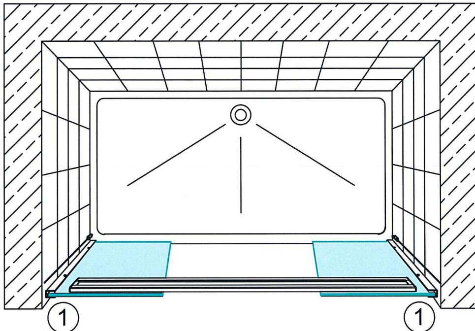
① POSIZIONARE IL PROFILO A 2 cm. DAL BORDO, METTERE A PIOMBO, SEGNARE I FORI, FORARE (punta  $\varnothing$  mm.6) E FISSARE I PROFILI.
